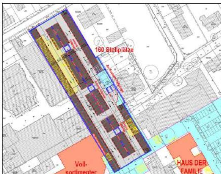
Bild 26: Entwurf für eine Tiefgaragenebene zur Neuorganisation des Stellplatzangebots für das langfristige Flächen-Szenario A
