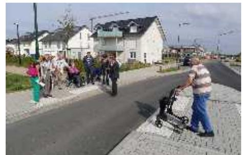
An **ungesicherten** Querungsstellen (Nebenstraßen, verkehrsberuhigte Zonen etc.) wird ein üblicher Rundstein mit einer Einbauhöhe von **2 cm** zur Anwendung kommen, der von Rollstuhlfahrern noch zu überfahren und von Sehbehinderten, mit einem zusätzlichen Richtungsfeld, tastbar ist.
